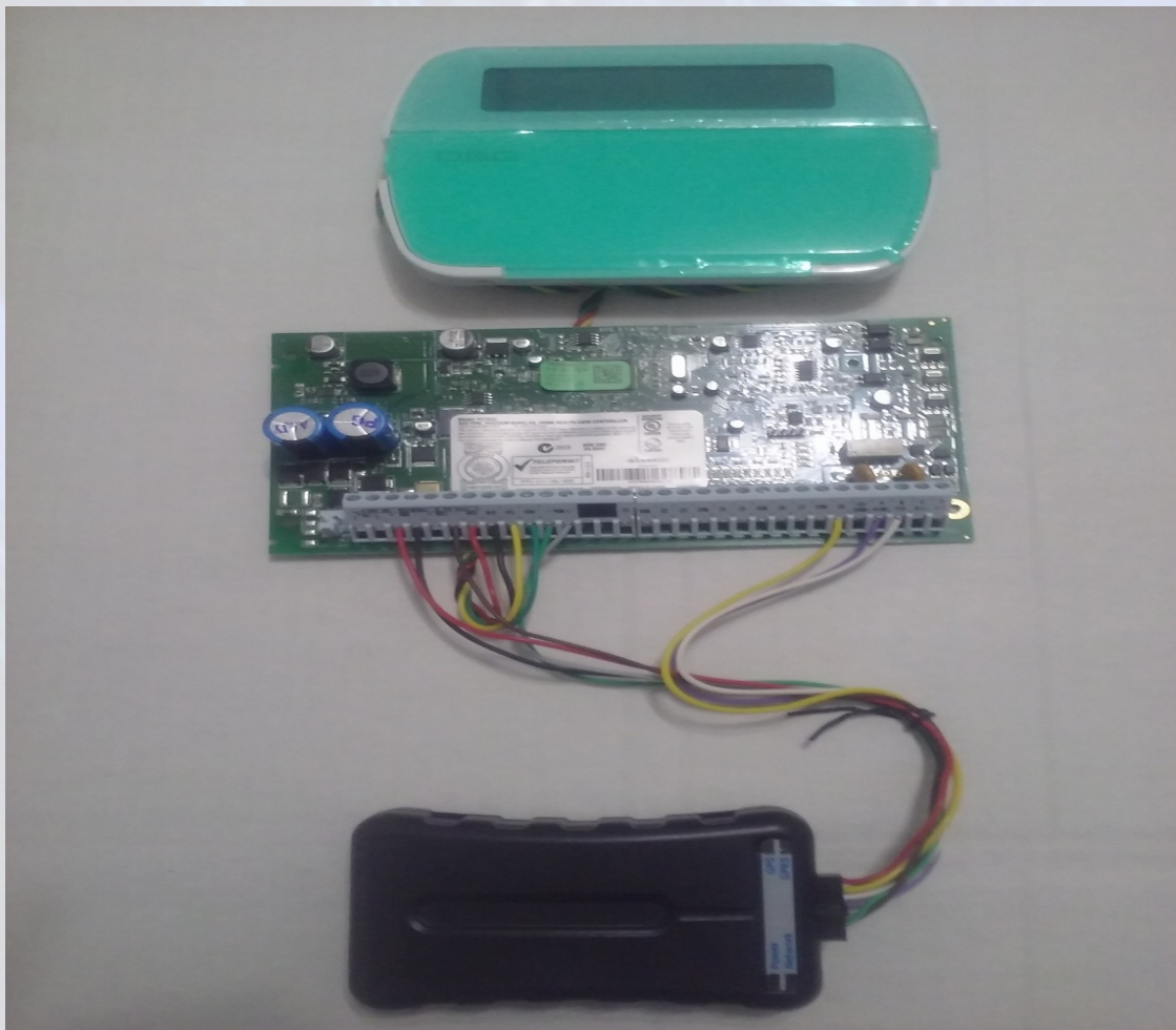
CONEXIONADO EN UNA ALARMA DSC PC-1832
